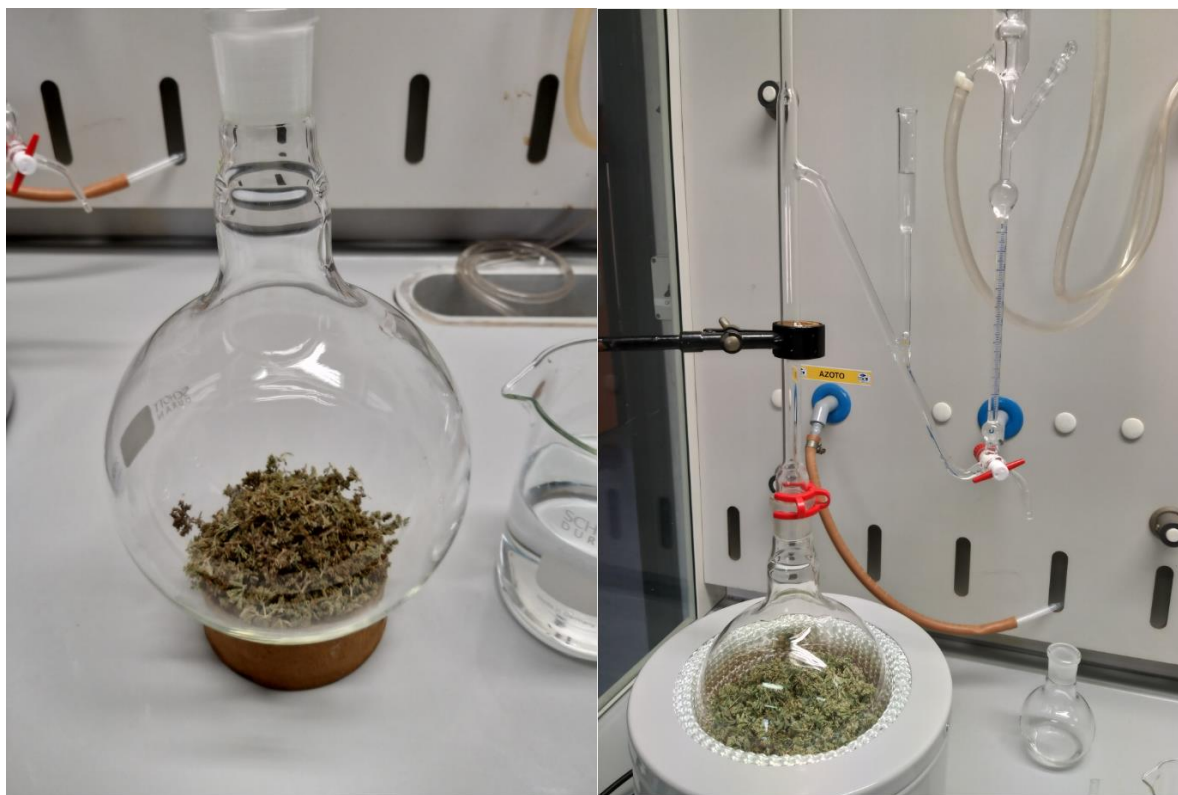
Figura 2. Metodo di estrazione degli oli essenziali con strumentazione Clevenger
